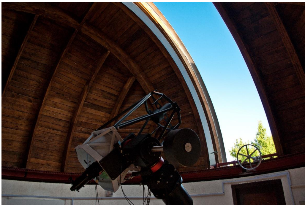
Слика 2. Телескоп Недељковић пречника главног огледала од 60 цм у старом посматрачком павиљону.
