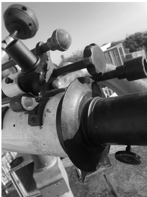
Слика 7: Стање носача фокуса и завртања за фино померање.
