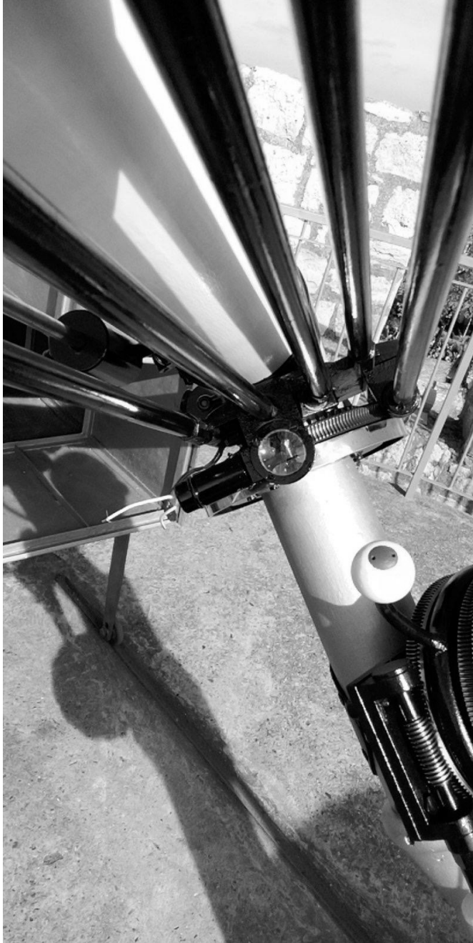
Слика 21: Приказ додате лупе за очитавање деклинацијског круга. Могу се уочити завртњи за фино померање, ректасцензијски зупчаници и груба кочница. Са леве стране се види шина која носи контратег након враћања оригиналног сјаја.
