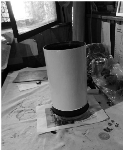
Слика 17: Росник након враћања оригиналне боје и фиксирања објектива.
