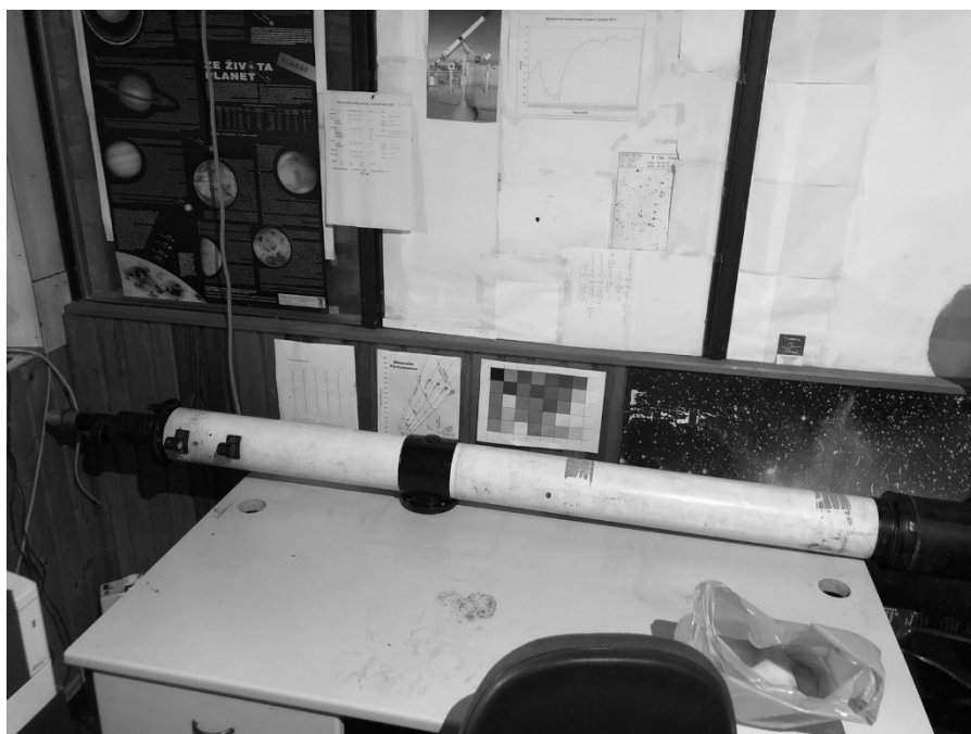
Слика 11: Изглед тубуса Цајсовог рефрактора пре реконструкције.
