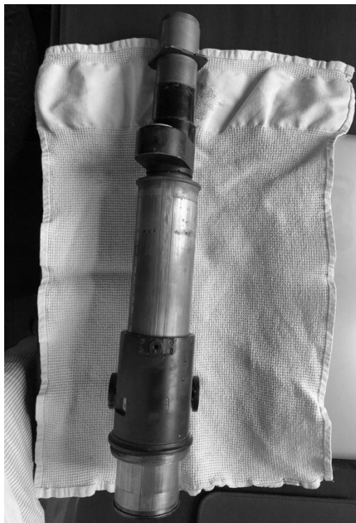
Слика 8: Фокусер и претходни носач окулара у затеченом стању.
