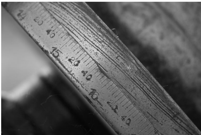
Слика 6: Изглед ректасцензијског подеоног круга пре реконструкције.
