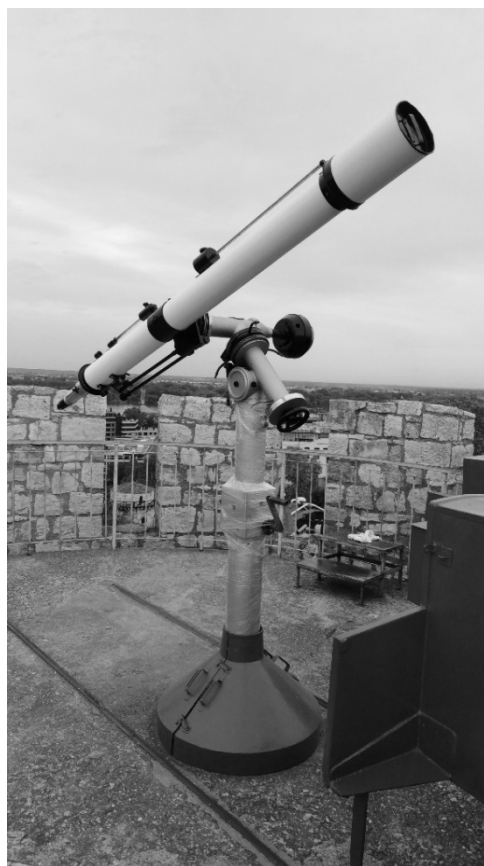
Слика 15: Телескоп Цајс 110/2030 mm после рестаурације.
