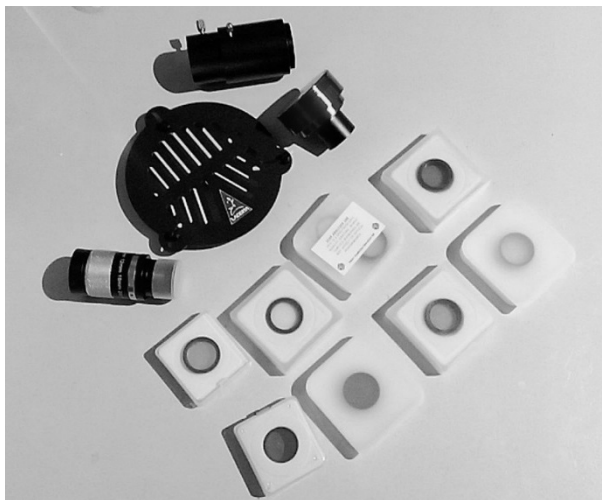
Слика 13: Нова астрономска опрема. У горњем делу су: астрокамера са адаптером, Бахтинов маска и окулар са променљивом жижном даљином. Испод је сет различитих филтера и дифракциона решетка.
